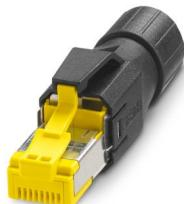
Conector enchufable RJ45, diseño: RJ45, índice de protección: IP20, número de polos: 8, 10 GBit/s, CAT6<sub>A</sub>, material: Plástico, tipo de conexión: Conexión por desplaz. de aislamiento, sección de conexión: AWG 26- 24, salida de cables: recta, color: negro, Ethernet
