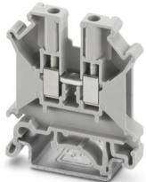
Borne de paso, tensión nominal: 800 V, corriente nominal: 32 A, número de conexiones: 2, tipo de conexión: Conexión por tornillo, Sección de dimensionamiento: 4 mm<sup>2</sup>, sección: 0,2 mm<sup>2</sup> - 6 mm<sup>2</sup>, clase de montaje: NS 35/7,5, NS 35/15, NS 32, color: gris
