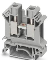
Borne de paso, tensión nominal: 800 V, corriente nominal: 57 A, número de conexiones: 2, tipo de conexión: Conexión por tornillo, Sección de dimensionamiento: 10 mm<sup>2</sup>, sección: 0,5 mm<sup>2</sup> - 16 mm<sup>2</sup>, clase de montaje: NS 35/7,5, NS 35/15, NS 32, color: gris
