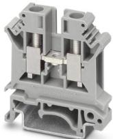
Borne de paso, tensión nominal: 800 V, corriente nominal: 41 A, número de conexiones: 2, tipo de conexión: Conexión por tornillo, Sección de dimensionamiento: 6 mm<sup>2</sup>, sección: 0,2 mm<sup>2</sup> - 10 mm<sup>2</sup>, clase de montaje: NS 35/7,5, NS 35/15, NS 32, color: gris
