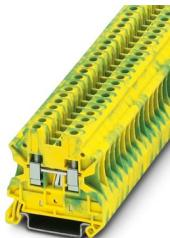
Borna de tierra, número de conexiones: 2, tipo de conexión: Conexión por tornillo, sección: 0,14 mm<sup>2</sup> - 6 mm<sup>2</sup>, clase de montaje: NS 35/7,5, NS 35/15, color: amarillo-verde
