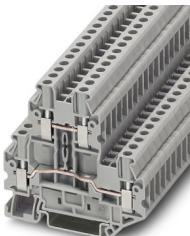
Borne de doble piso, tensión nominal: 500 V, corriente nominal: 24 A, tipo de conexión: Conexión por tornillo, Sección de dimensionamiento: 2,5 mm<sup>2</sup>, sección: 0,14 mm<sup>2</sup> - 4 mm<sup>2</sup>, clase de montaje: NS 35/7,5, NS 35/15, color: gris
