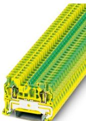
Borne de tierra de conexión por resorte, número de conexiones: 2, tipo de conexión: Conexión por resorte, Sección de dimensionamiento: 2,5 mm<sup>2</sup>, sección: 0,08 mm<sup>2</sup> - 4 mm<sup>2</sup>, clase de montaje: NS 35/7,5, NS 35/15, color: amarillo-verde
