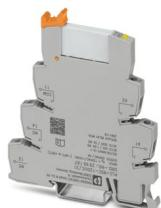
Interfaz PLC, compuesta por borne de base PLC-BSC.../21 con conexión por tornillo y relé miniatura enchufable con contacto de potencia, para el montaje sobre carril NS 35/7,5, 1 contacto comutado, tensión de entrada 120 V AC/110 V DC
