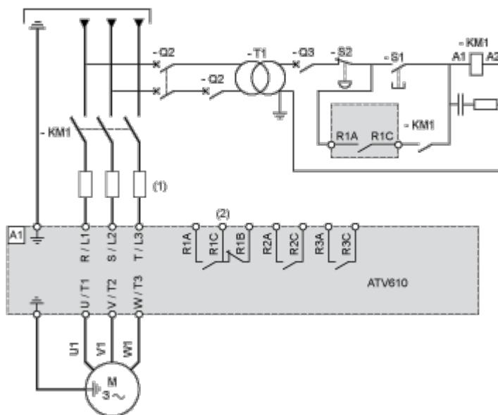
**Diagrama de cableado del bloque de control**
