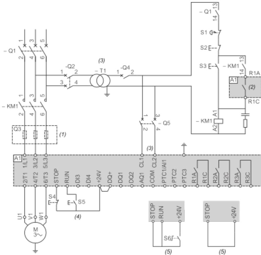
(1): Instalación de fusibles de acción rápida adicionales para mejorar la coordinación de tipo 2 de acuerdo con la norma IEC 60947-4-2.
