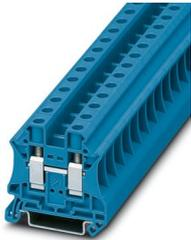
Borne de paso, tensión nominal: 1000 V, corriente nominal: 57 A, número de conexiones: 2, tipo de conexión: Conexión por tornillo, Sección de dimensionamiento: 10 mm<sup>2</sup>, sección: 0,5 mm<sup>2</sup> - 16 mm<sup>2</sup>, clase de montaje: NS 35/7,5, NS 35/15, color: azul
