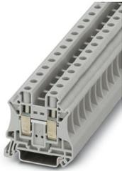
Borne de paso, tensión nominal: 1000 V, corriente nominal: 57 A, número de conexiones: 2, tipo de conexión: Conexión por tornillo, Sección de dimensionamiento: 10 mm<sup>2</sup>, sección: 0,5 mm<sup>2</sup> - 16 mm<sup>2</sup>, clase de montaje: NS 35/7,5, NS 35/15, color: gris
