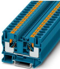
Borne de paso, tensión nominal: 1000 V, corriente nominal: 57 A, número de conexiones: 2, tipo de conexión: Conexión push-in, Sección de dimensionamiento: 10 mm<sup>2</sup>, sección: 0,5 mm<sup>2</sup> - 16 mm<sup>2</sup>, clase de montaje: NS 35/7,5, NS 35/15, color: azul
