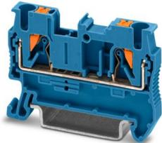
Borne de paso, tensión nominal: 800 V, corriente nominal: 24 A, número de conexiones: 2, número de polos: 1, tipo de conexión: Conexión push-in, Sección de dimensionamiento: 2,5 mm<sup>2</sup>, sección: 0,14 mm<sup>2</sup> - 4 mm<sup>2</sup>, clase de montaje: NS 35/7,5, NS 35/15, color: azul
